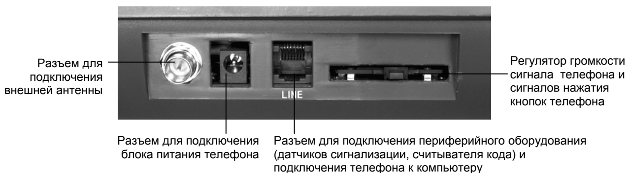
Рис. 2. Разъемы и регулятор громкости на задней поверхности телефона.
